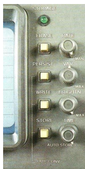
Conjunto de mandos destinados al control de las diferentes formas de operación de memoria en un osciloscopio.
