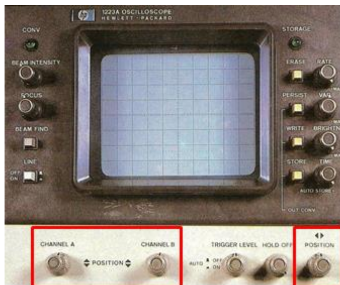
Potenciómetros que regulan la situación del haz sobre la pantalla en su posición vertical y horizontal.
